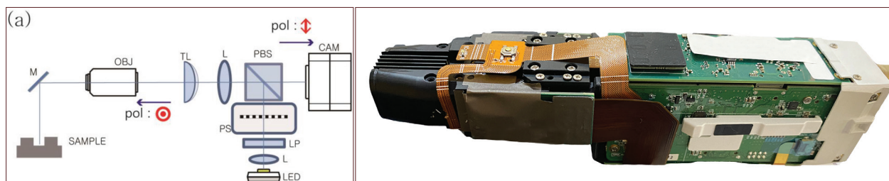
تصویر ۲-۱. ساختار یک اسکنر داخل دهانی، چگونگی تولید نور و دریافت تصویر از سطوح را نشان می‌دهد. (۱)
