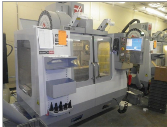
شکل ۳-۱.۱ مرکز میلینگ سی ان سی با محور عمودی اس وی اف- ۲ تی آر ۲
