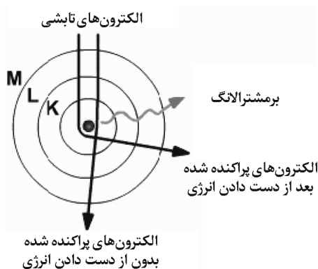
شکل ۵-۱ تولید اشعه x به روش عمومی (برمشترالانگ)
