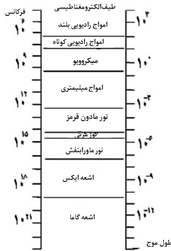
شکل ۳-۱ طیف امواج الکترومغناطیسی. مقادیر طول موج و فرکانس امواج مختلف نشان داده شده است.
